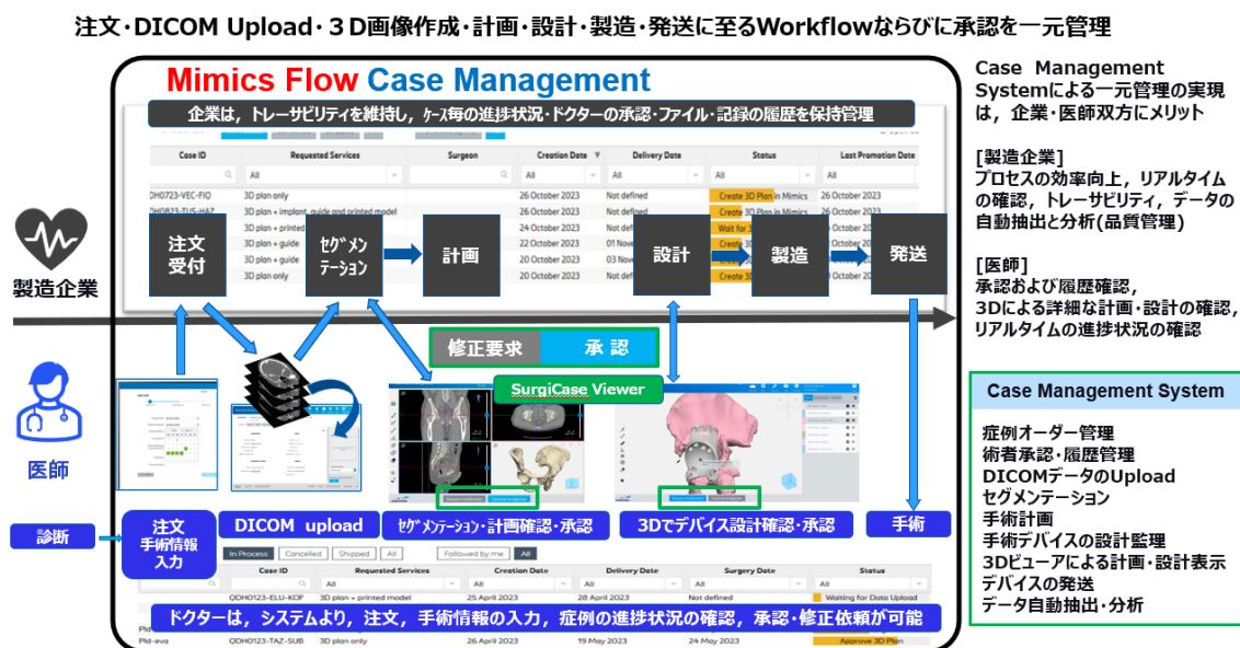
解説図3 カスタムインプランの受注から製造・出荷までのイメージ
